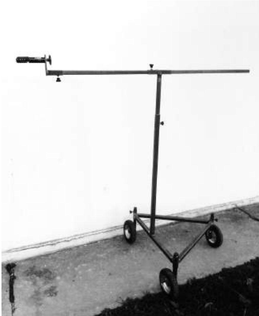
Figura 3.14. Supporto utilizzato scattare le foto da posizione perfettamente verticale sopra ogni parcella
