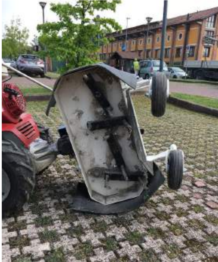
Figura 3.8. Organo di lavoro della macchina scerbatrice
